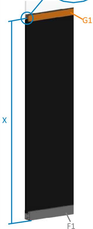
Reportez ensuite la cote X sur les profils de porte (D1) et percez des trous  $\text{\O}5,5\text{mm}$ . Puis assemblez les profils de porte à l'empilage vu précédemment à l'étape 8. L'assemblage doit se faire à plat.
