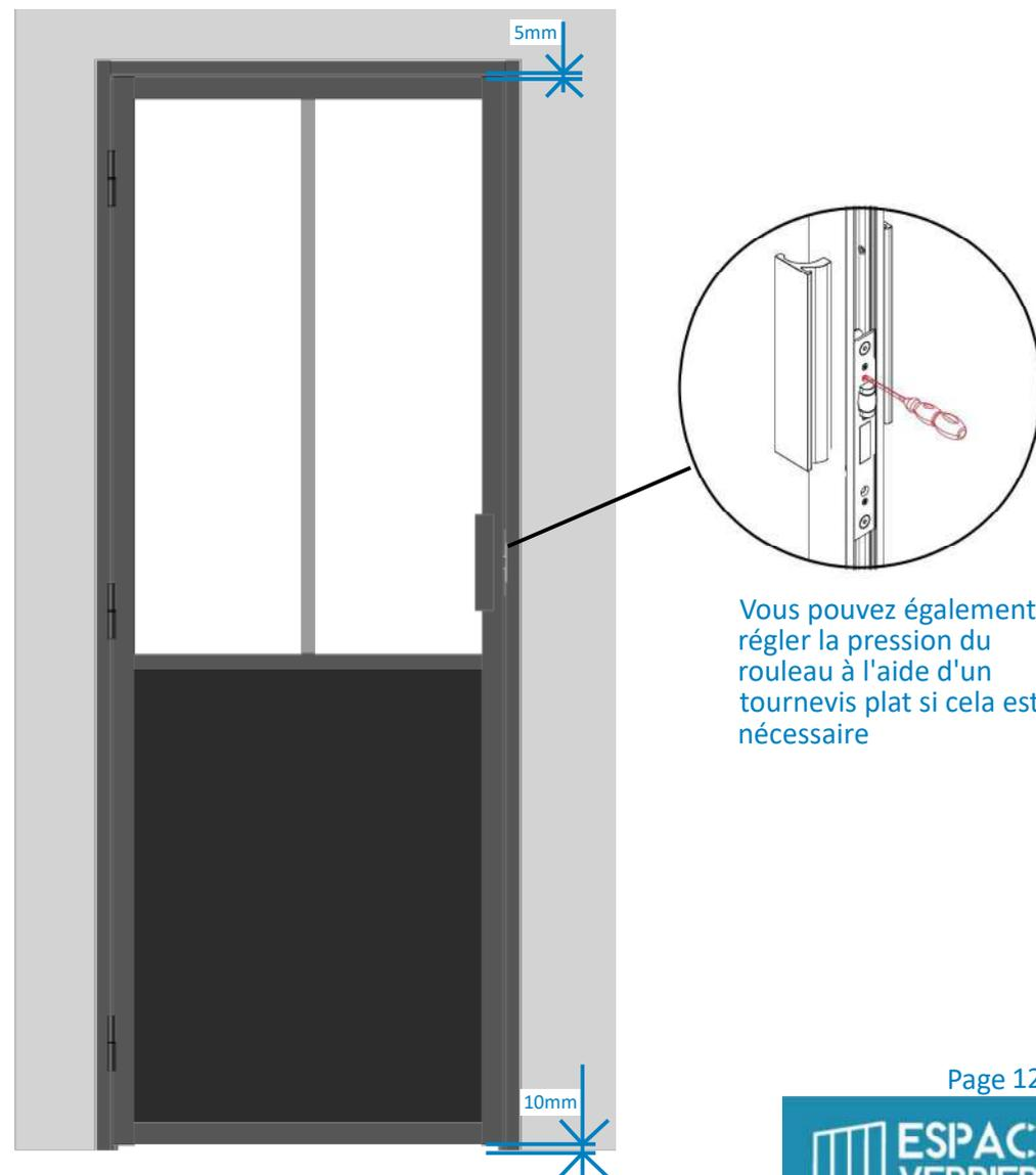
Vous pouvez également régler la pression du rouleau à l'aide d'un tournevis plat si cela est nécessaire
