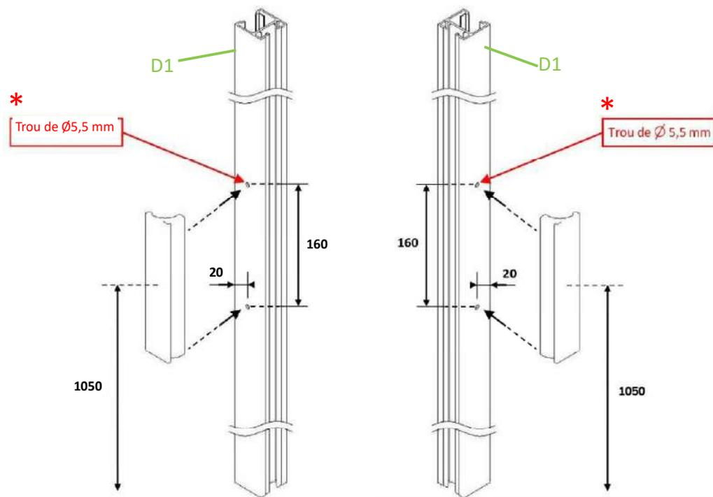
\*Les perçages sont à réalisés des deux côté du profil
